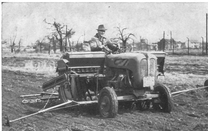
Fig. 10 Tracteur équipé d'un semoir (monté entre les essieux) et d'une herse à semis
