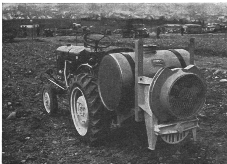
Fig. 16 Atomiseur porté comprenant pompe à pistons et ventilateur du type axial.
