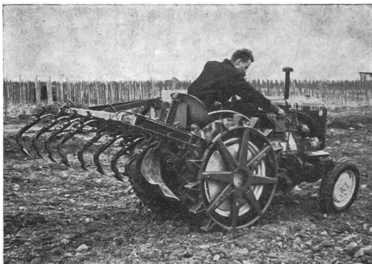
Fig. 13 Tracteur ordinaire à voie étroite équipé d'un cultivateur et dont les roues arrière comportent une garniture de crampons.
