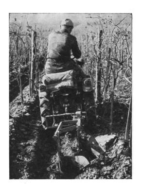
En exécutant un labour de chaussage avec un tracteur vigneron tirant une charrue à deux corps, il est possible de travailler jusqu'à un taux d'inclinaison de 18 à 20 % suivant le sens des courbes de niveau et jusqu'à 20 % selon le sens de la pente.
