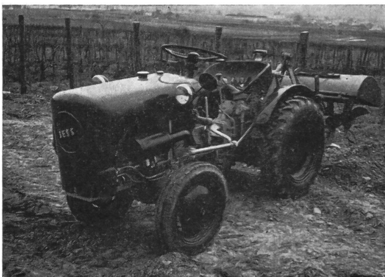
Fig. 15 Tracteur ordinaire à voie étroite équipé d'une fraiseuse portée à lames coudées.
