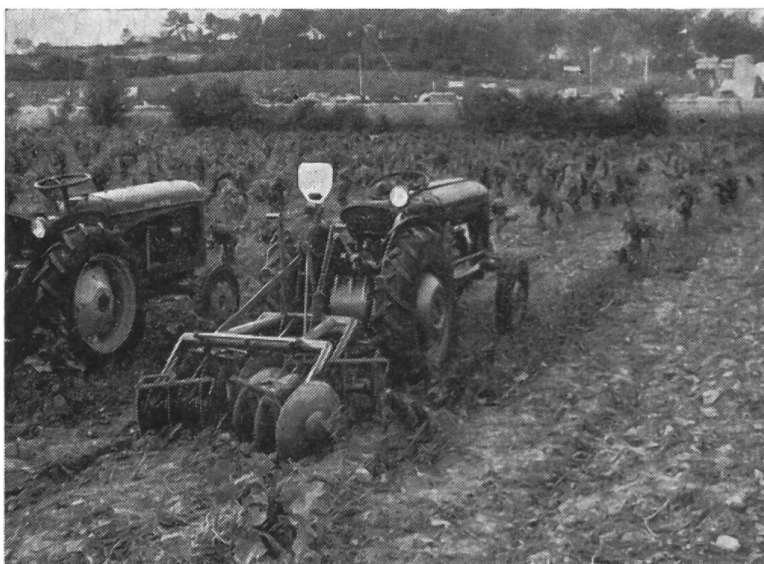
Fig. 14 Tracteur ordinaire à voie étroite tirant un pulvérisateur à disques du type tandem.
