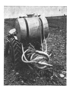
Fig. 17 Atomiseur porté accompagné d'une pompe centrifuge et de deux ventilateurs
