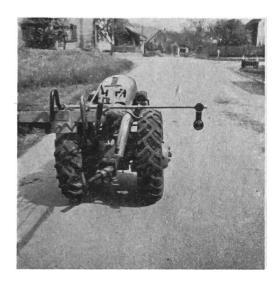
Fig. 14 et 15: Prototype d'appareil de signalisation nocturne destiné aux machines motorisées à un essieu (feu arrière et dispositif réfléchissant). Il ne convient toutefois pas pour celles qui sont équipées d'une installation d'allumage par magnéto.
