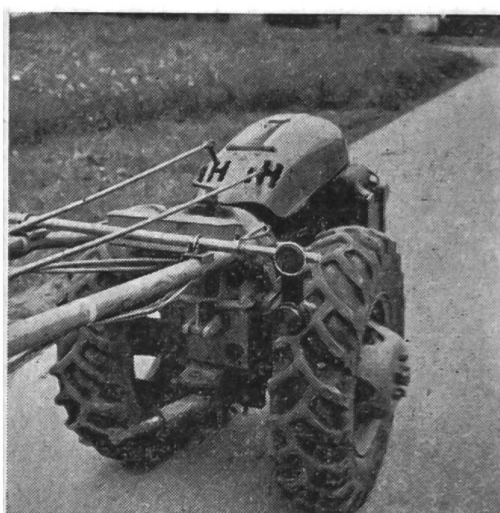
Fig. 14 et 15: Prototype d'appareil de signalisation nocturne destiné aux machines motorisées à un essieu (feu arrière et dispositif réfléchissant). Il ne convient toutefois pas pour celles qui sont équipées d'une installation d'allumage par magnéto.
