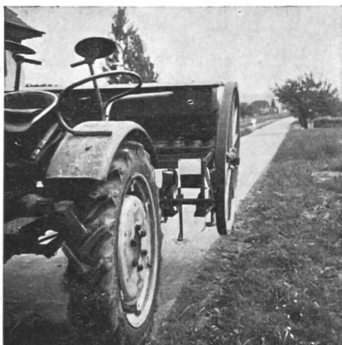
Fig. 11 et 12: Les machines portées par le tracteur peuvent se montrer dangereuses pour les autres usagers de la voie publique dès qu'elles sont plus larges que le tracteur ou qu'elles dépassent beaucoup à l'arrière (les charrues, par exemple). Les parties dépassantes doivent être suffisamment signalisées à l'aide de dispositifs réfléchissants. Si la machine portée masque les feux arrière du tracteur, il faut qu'un feu rouge soit monté à l'arrière de cette dernière, à gauche.
