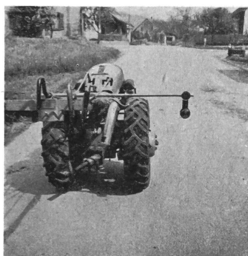
Fig. 14 et 15: Prototype d'appareil de signalisation nocturne destiné aux machines motorisées à un essieu (feu arrière et dispositif réfléchissant). Il ne convient toutefois pas pour celles qui sont équipées d'une installation d'allumage par magnéto.
