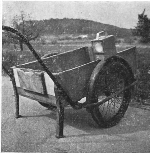
Fig. 9 et 10: Charrette à lait correctement signalisée pour circuler dans l'obscurité: 2 dispositifs réfléchissants rouges à l'arrière, 2 dispositifs réfléchissants blancs à l'avant, un dispositif éclairant latéral donnant une lumière rouge en arrière et une lumière blanche en avant.
