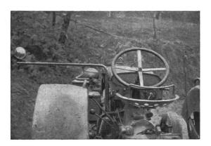
L'appareil de signalisation à rétroviseur et clignoteur est cependant plus sûr et plus rationnel.
