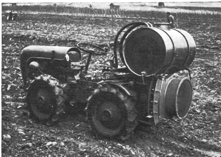
Fig. 2 Tracteur spécial à 4 roues motrices prévu pour la viticulture (instrument porté: atomiseur employé également pour la protection des plantes contre les parasites)
