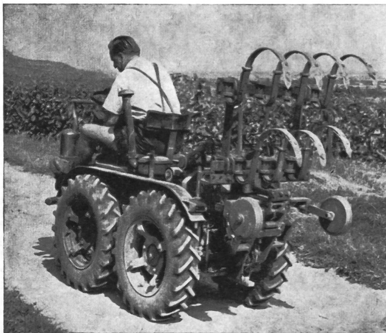
Fig. 3 Les instruments de travail doivent pouvoir être relevés à la verticale afin que l'on ait des chaînes aussi étroites que possible
