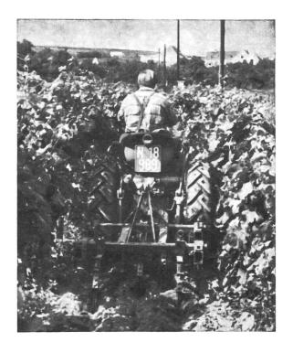
d'une certaine puissance lors de l'apparition des atomiseurs, des poudreuses à grand travail et des fraiseuses, du fait que ces équipements nécessitent souvent une force d'entraînement de 10 c h et plus. Par ailleurs, une certaine proportion de tracteurs vignerons proprement dits comportent 4 roues motrices afin de pouvoir fournir un effort de traction suffisant en dépit de leur faible poids et du petit format de leurs roues.
