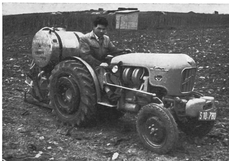
Fig. 7 Tracteur vigneron à roues motrices arrière, équipé d'un moteur de 28 ch (instrument porté: atomiseur pour les traitements antiparasitaires dans les vignobles et les houblonnières)
