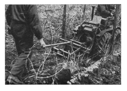
de transmission. Les deux essieux sont rigides et non dirigeables, la direction du mototracteur étant rendue possible grâce à un pivot central combiné avec un système de direction ordinaire à volant.
