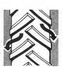
de la terre collante ne peut pas s'agripper aux flancs trapézoïdaux du profil et se détache facilement dès que la partie correspondante du pneu quitte le sol
