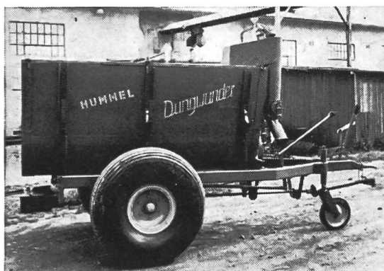
Epandeuse «Dungwunder» semi-portée pour engrais liquides (purin + eau + fumier émietté) comportant un disque distributeur rotatif et une pompe pour liquides chargés.
