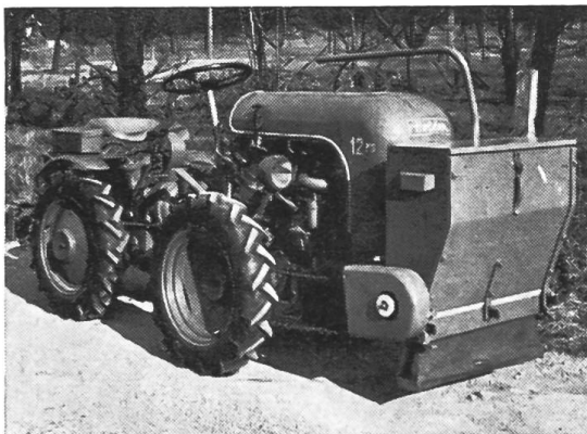
Distributeur d'engrais frontal porté «Rauch» pour cultures spéciales (vignobles, vergers, houblonnières)
