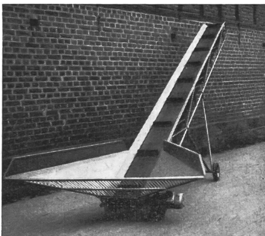
L'élévateur «Firo» à pommes de terre et betteraves comporte une très large trémie d'alimentation de 1 m 80. Il peut être placé directement derrière l'épanduse de fumier.
