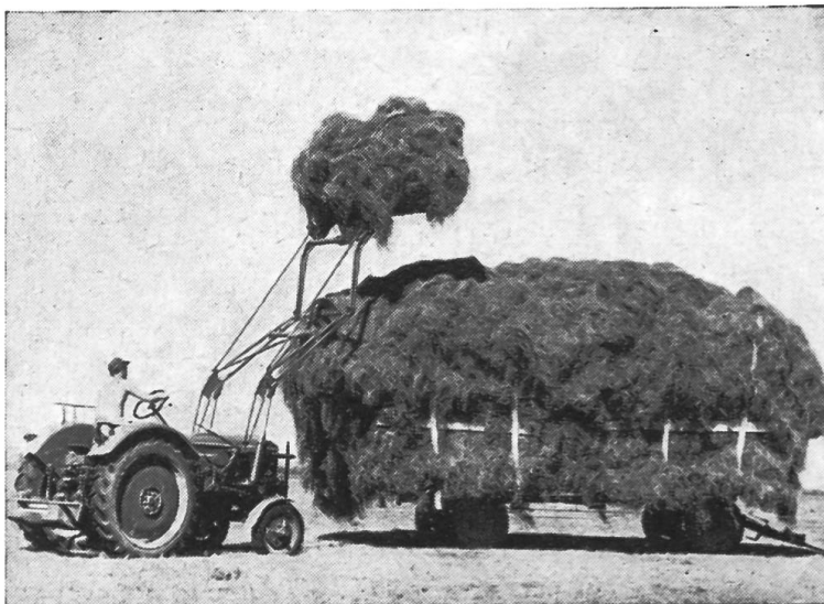
Fig. 2: Chargeur frontal complété par des allonges pour le ramassage des four- rages secs
