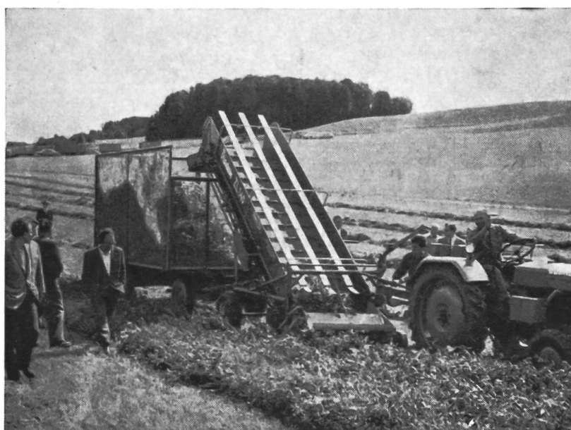
Fig. 3: Ramasseuse-chargeuse de fourrages à ruban sans fin comportant des barrettes à dents et équipée d'un ruban expulseur terminal à rotation rapide (vue ici lors du chargement de l'herbe)
