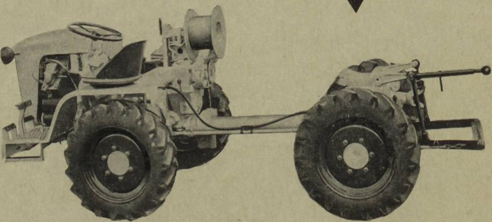
Possibilité d'accoupler tous instruments (barre faucheuse, herse rotative commandée, pulvériseur arboricole, etc.). Avec long empattement et plateau de charge, constitue un véhicule tous-terrains aux performances extraordinaires.
