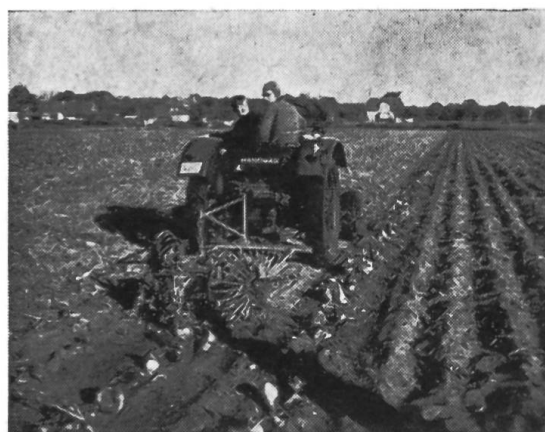
La nouvelle arracheuse aligneuse à disques «Kopmann» pour la récolte des betteraves
