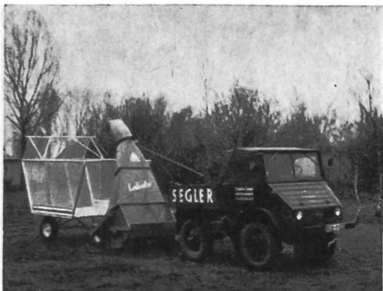
Benne basculante «Segler» pour fourrages hachés, destinée spécialement à la récolte journalière de l'herbe.
