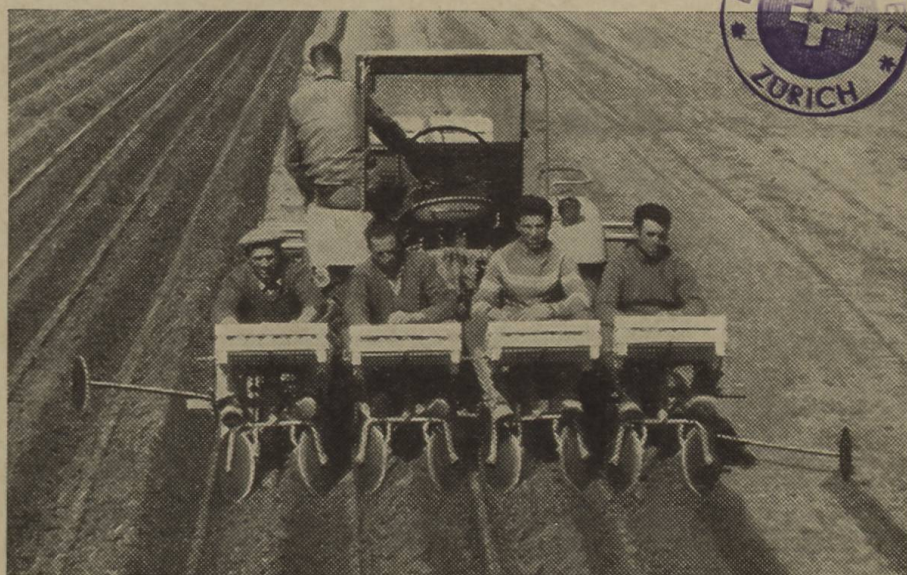
Plantation de pommes de terre sur 4 rangs avec nos planteuses semi-automatiques brevetées. En plantant, le pilotage en pente est possible.
