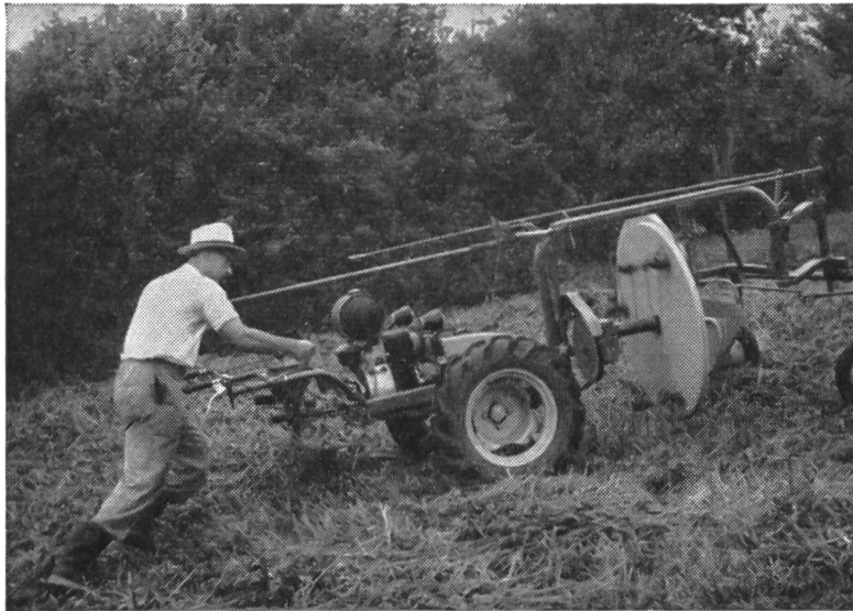
Fig. 3: Motofaucheuse accou- plée à un râteau frontal combiné et travaillant sur un pré de 45 % de déclivité.
