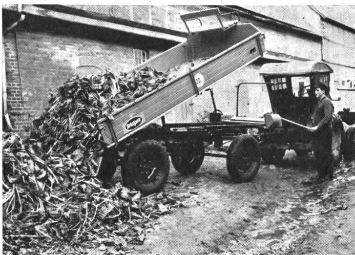
Fig.5: La manœuvre des remorques agraires à basculement trilatéral (vidage de la charge des deux côtés et à l'arrière) n'exige pas de gros efforts. Le système basculeur employé ici est du type mécanique, la caisse étant actionnée par l'intermédiaire d'un pignon et d'une crémaillère.
