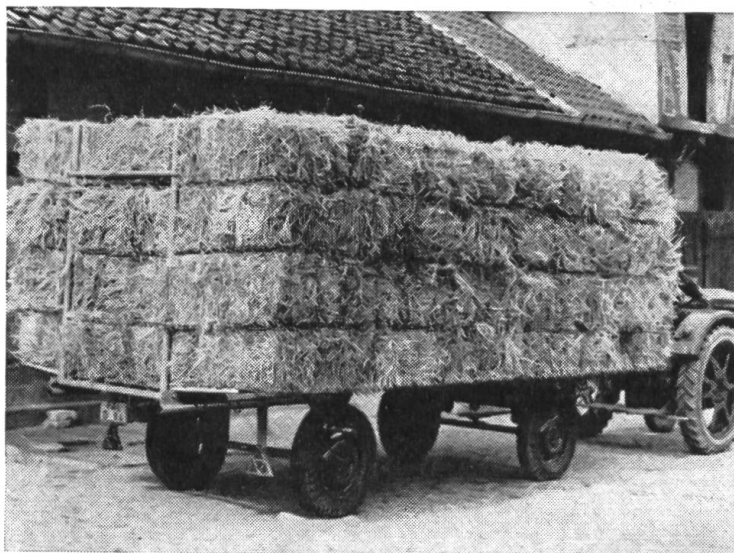
Fig. 2: Remorque agraire pourvue d'une échelle à l'avant et à l'arrière. Ses ridelles peuvent être mises en position horizontale pour certains transports (balles de paille, par exemple), ce qui permet d'augmenter de façon notable la surface de chargement du plateau.
