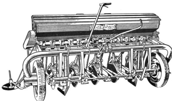
**Nouveauté!** Le semoir **NODET** sème avec précision sur une largeur de 2,3 m à 2,7 m. Entraînement des 2 côtés. La surveillance du débit peut s'opérer depuis le siège du tracteur.
