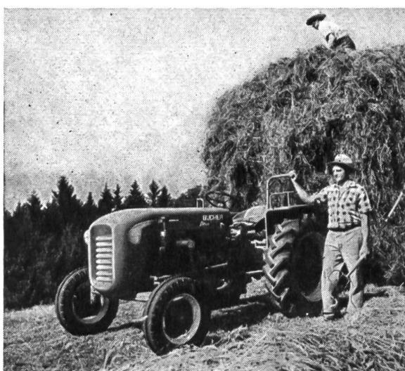
BUCHER D 4000 avec 10 marches avant de 8,8 à 20 km/h, marches rampantes de 0,17 à 0,8 km/h et 2 marches arrière de 1,2 et 5,4 km/h, différentiel blocable, dispositif antipatinage (alourdissement hydraulique momentané des roues AR) et embrayage télécommandé.
