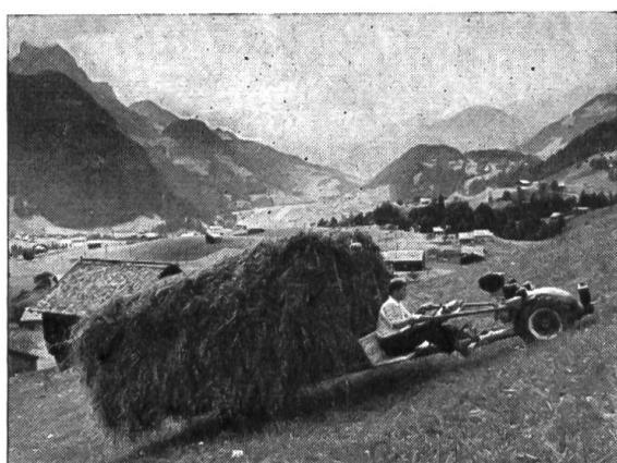
K 5, la toute dernière réalisation BUCHER: une machine de traction et de récolte à utilisations multiples, avec différentiel, commande de lame de conception nouvelle à système de protection pour les sections, hauteur de coupe réglable, mécanisme de coupe inclinable, prise de force à l'arrière et à l'avant.
