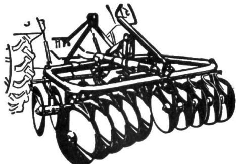
**Herse à disques.** Construction tubulaire très solide. Commande de l'inclinaison des disques depuis le siège du tracteur. Avec disques lisses ou dentelés.
