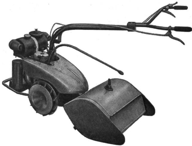
Le petit tracteur à 2 roues BUCHER K 4, machine polyvalente pour les travaux de culture, de traction et de récolte. Equipements: barre de coupe, dispositifs andaineur et javelleur, faneur, remorque à essieu moteur, etc.
