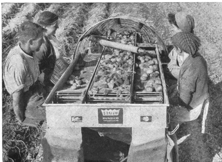
Fig. 4a et 4b: Arracheuses-ramasseuses proprement dites
