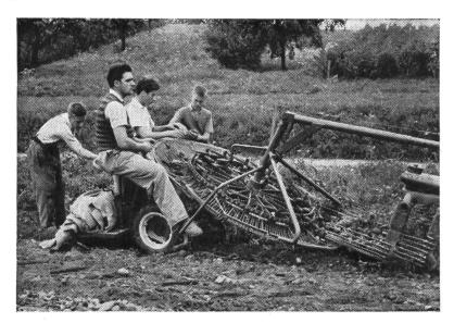
Une typique représentante de ces matériels est l'arracheuse à cribles oscillants reproduite sur la fig. 2. A la sortie des cribles, les tubercules sont repris par une roue oblique à claire-voie, derrière laquelle sont assises les personnes chargées du triage. Elles retirent les pommes de terre pour les mettre dans des sacs, tandis que les corps étrangers (mottes, pierres, mauvaises herbes, restes de fanes) sont automatiquement déposés à terre.
