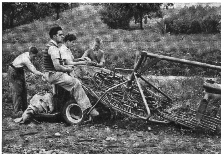
Fig. 2a: Arracheuse-aligneuse à cribles oscillants complétée par un élévateur
