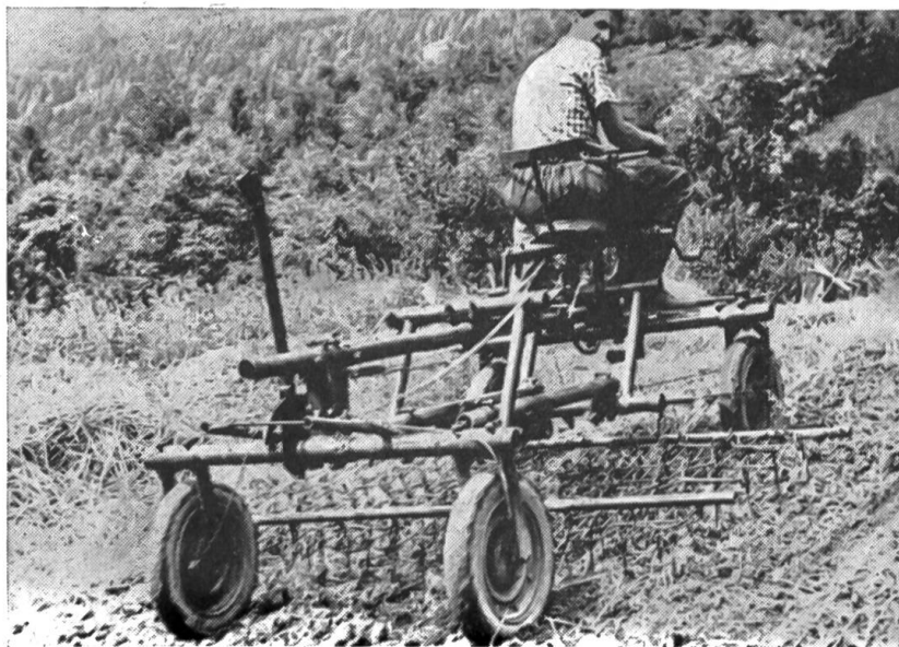
Fig. 7: Herse-étrille raccourcie d'une série d'éléments pour son montage entre les essieux
