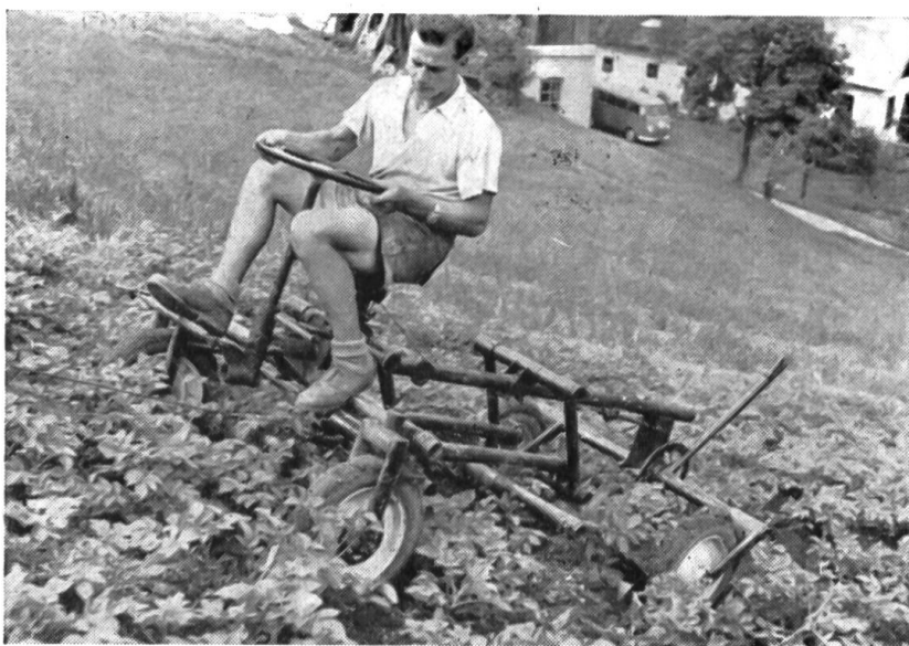
Fig. 8: Le buttage des pommes de terre effectué avec le porte-outils de Reindorf
