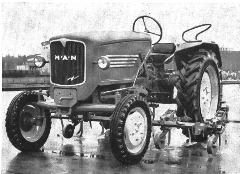
Montage d'un équipement de sarclage pour pommes de terre entre les essieux d'un tracteur à long empattement
