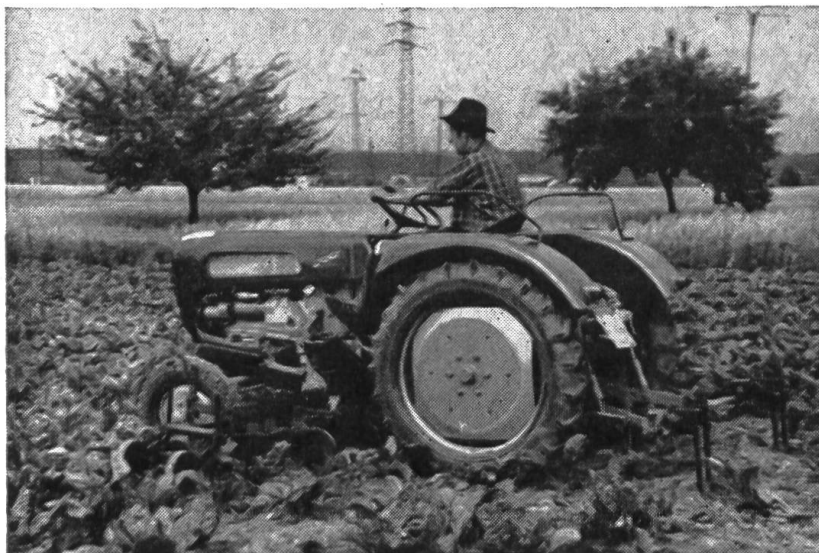
Tracteur avec barre porte-outils centrale et griffes effaceuses de traces effectuant un sarclage dans une culture de betteraves
