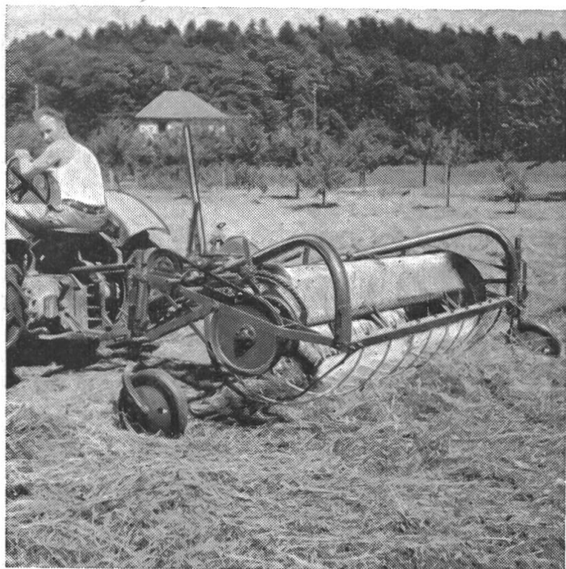
Fig. 3: Râteau andaineur à rotation circulaire
