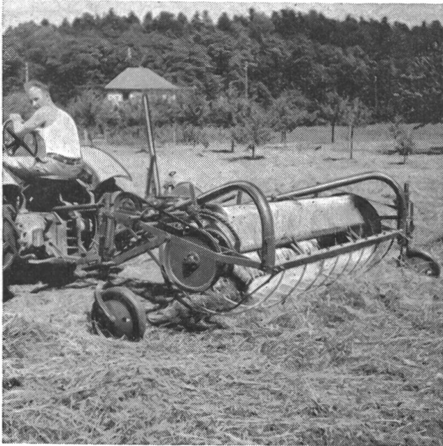
Fig. 3: Râteau andaineur à rotation circulaire
