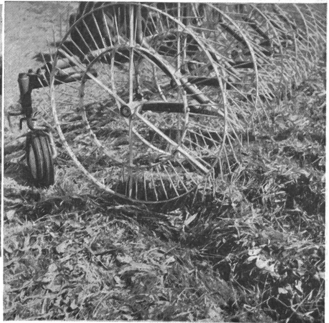
Fig. 6: Retournement du fourrage étalé au moyen d'un râteau à disques orientables
