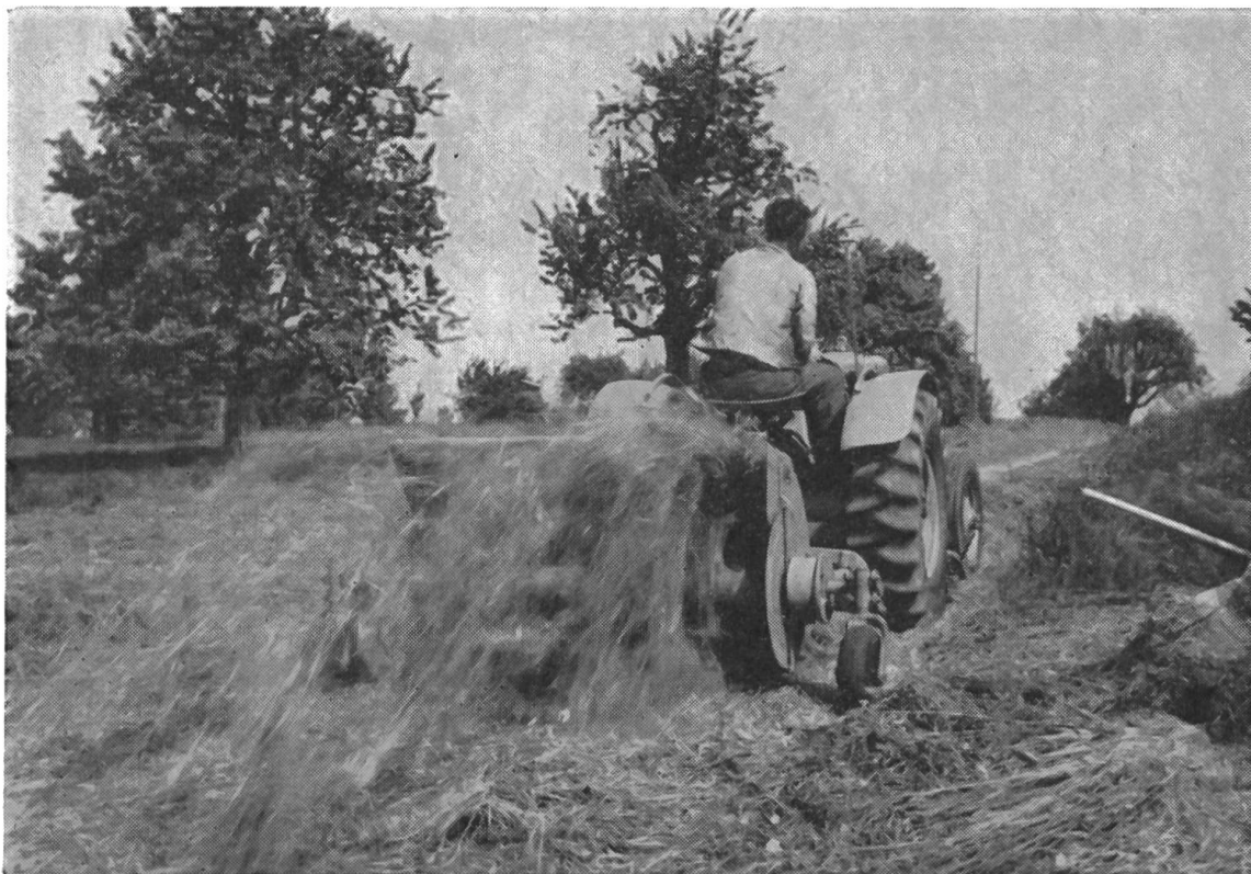
Fig. 1: Epandeuse d'herbe (fauchage et éparpillement du fourrage vert en une seule opération)
