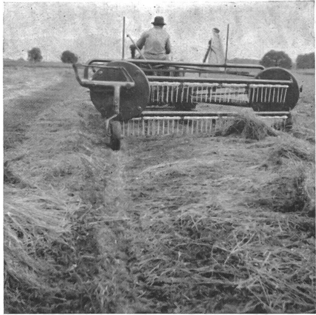
Fig. 4: Râteau andaineur combiné à rotation elliptique
