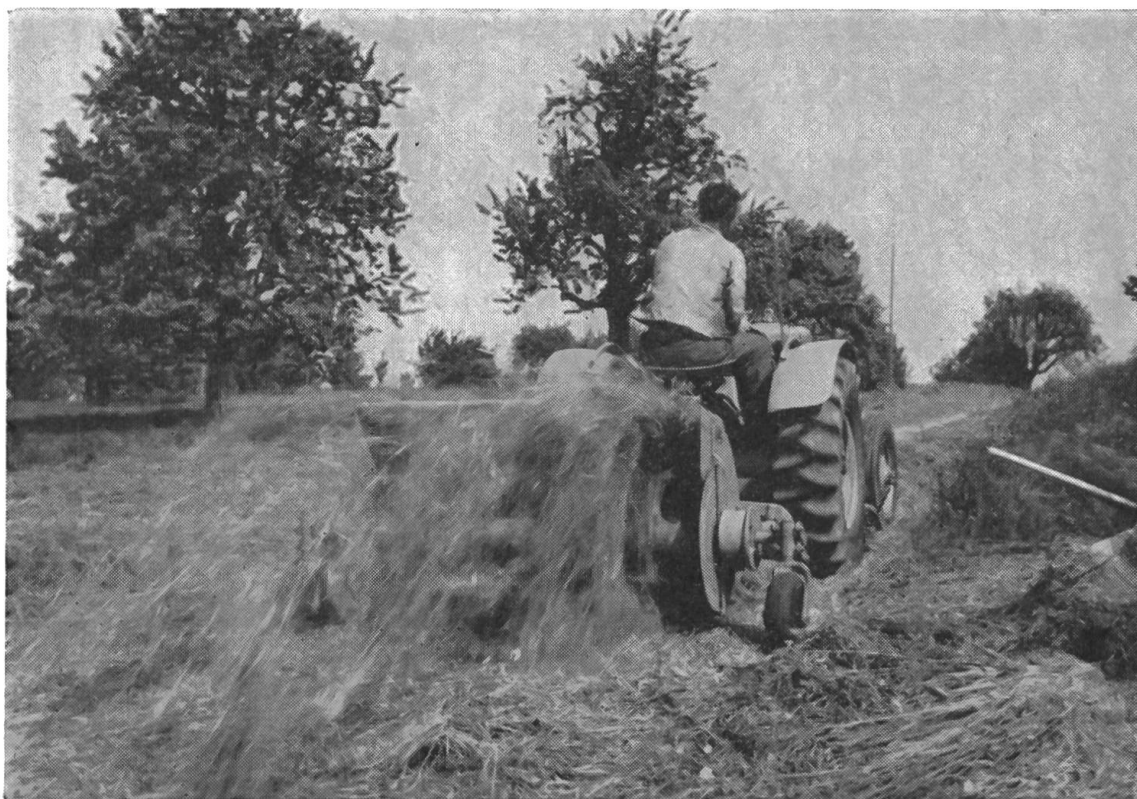
Fig. 1: Épandeuse d'herbe (fauchage et éparpillement du fourrage vert en une seule opération)
