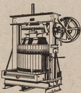
◀ **Pressoir à fruits** avec ou sans broyeurs. Différentes grandeurs avec entraînement à la main ou à moteur avec déclencheur automatique.
