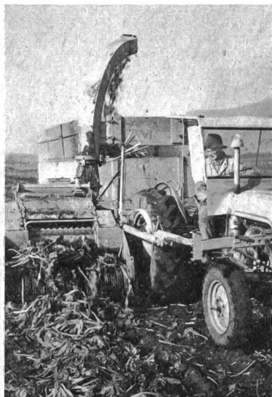
Fig. 10: Ramassage des feuilles de betteraves à sucre à l'aide de la ramasseuse-hacheuse-chargeuse.
