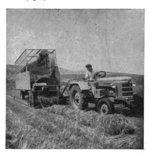
Fig. 3: Ramasseuse-hacheuse-chargeuse employée pour charger du foin.
