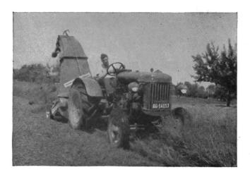
Fig. 2: Faucheuse-hacheuse-chargeuse attelée dans le plan de symétrie du tracteur (fauchage et épandage de foin).
