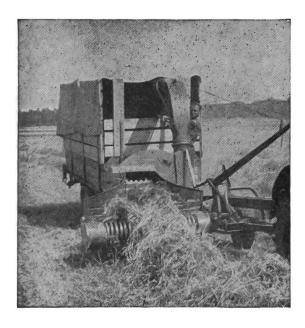
Fig. 1: Ramasseuse-hacheuse-chargeuse accouplée en déport à l'arrière du tracteur.
