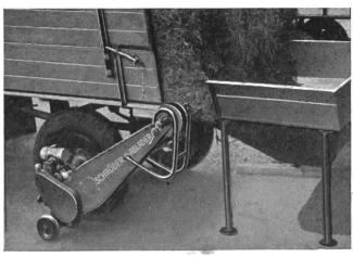
Fig. 16: Groupe motopropulseur sur brouette prévu pour l'entraînement du cylindre enrouleur.
