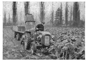
Fig. 8: Coupe et chargement de choux moelliers avec la faucheuse-hacheuse-chargeuse.
