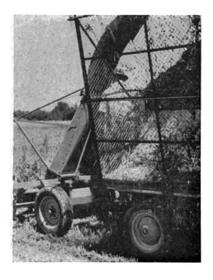
Fig. 14: Véhicule de récolte destiné au transport de produits hachés et équipé d'une cloison médiane pour déchargement bilatéral automatique.
