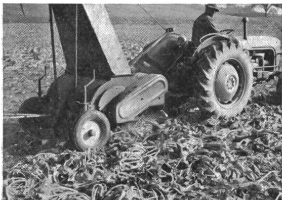
◀ Fig. 11: Décolletage et chargement des feuilles de betteraves à sucre avec la faucheuse-hacheuse-chargeuse.
