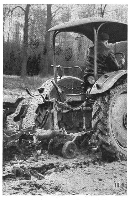
Deux roulettes sur axe oscillant, réglables en hauteur par une vis, sont suspendues à l'avant de la charrue.
