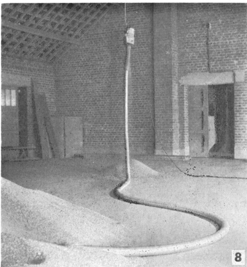
Les grains ou granulés sont véhiculés à l'intérieur d'un tube métallique souple par l'action de deux ressorts de diamètre, de pas et de section de fil différents, commandés à des vitesses différentes et dans des sens de rotation opposés par deux moteurs électriques jumelés et dont l'un tourne demi-vitesse de l'autre et en sens opposé.
