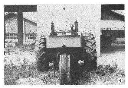
Cet autoculteur est porté par trois roues montées sur vérins indépendants à double effet, ce qui permet au tracteur:
