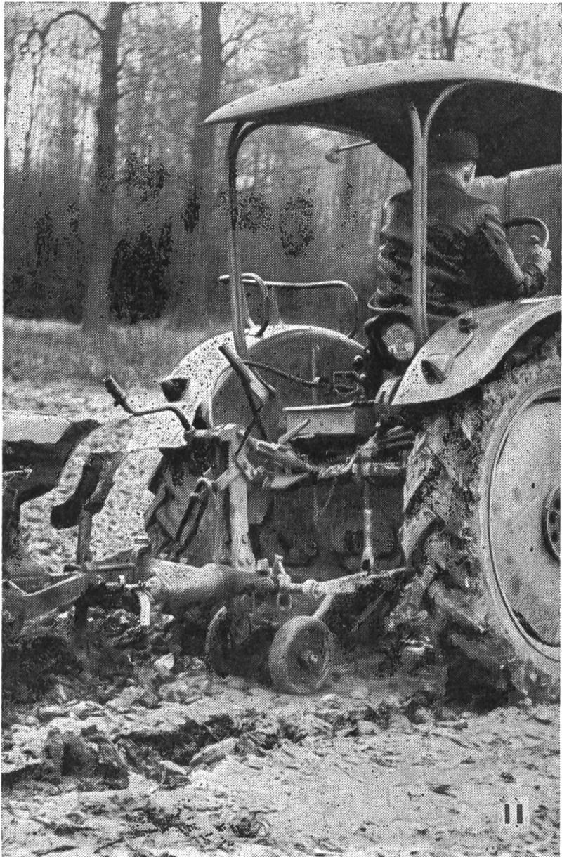
Deux roulettes sur axe oscillant, réglables en hauteur par une vis, sont suspendues à l'avant de la charrue.
