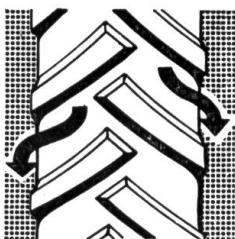
de la terre collante ne peut pas s'agripper aux flancs trapézoïdaux du profil et se détache facilement dès que la partie correspondante du pneu quitte le sol
