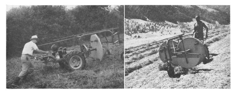
Fig. 1a et 1b: Machine de fanage à tambour oblique supportée par une et deux roulettes d'appui (faneur Aebi).
