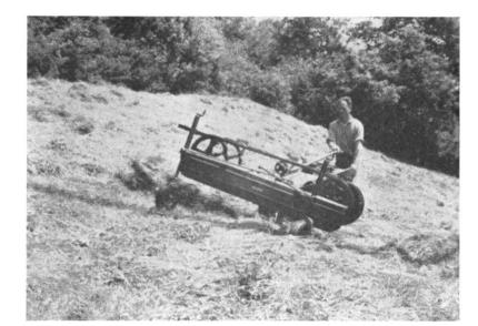
Fig. 4: Epandage de l'herbe lorsque le dispositif porte-râteaux a été mis en position fortement inclinée.
