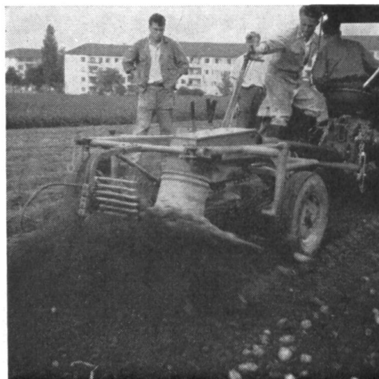
Fig. 4: Arracheuse-aligneuse de pommes de terre à trois grilles cribleuses rotatives.
