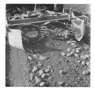
Fig. 3: Arracheuse-aligneuse de pommes de terre à cribles oscillants, pour deux lignes.
