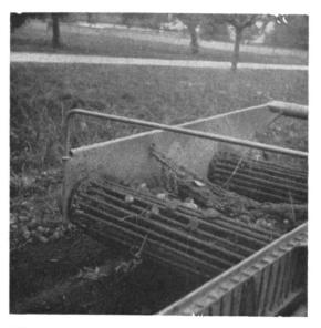
Fig. 2: Arracheuse-aligneuse de pommes de terre à tabliers secoueurs avec chaînes décrotteuses recevant les tubercules au bas du gradin.
