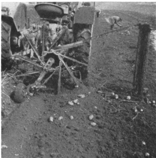
Fig. 1: Arracheuse de pommes de terre à fourches rotatives comportant roulette d'appui et tablier d'arrêt.
