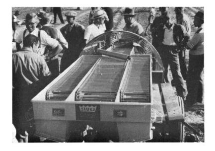
les tubercules et les corps étrangers sont amenés au poste de triage, autrement dit déposés sur la roue tournante. Grâce à la rotation de cette dernière, le produit est dirigé vers les personnes assises qui procèdent au tri, soit élevé jusqu'à une hauteur qui leur permet de travailler commodément.
