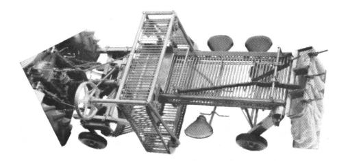
Fig. 6: Arracheuse-ramasseuse à pommes de terre comportant organes de séparation à secousses, élévateur et poste de triage.
