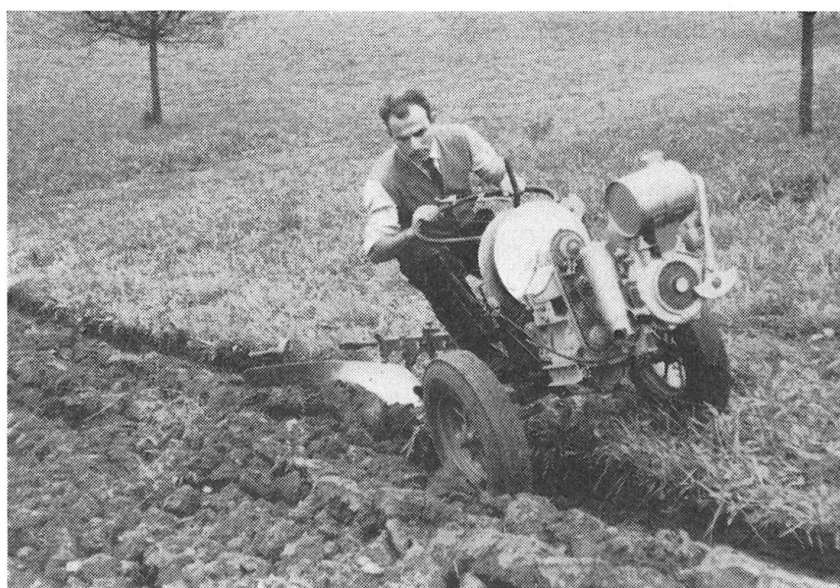
Fig. 9: Traction funiculaire à un seul desservant au moyen de l'«agrolift».
