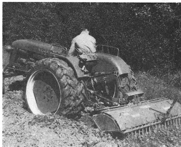
Fig. 8a: Labourage exécuté dans le sens de la pente avec un tracteur mi-lourd (degré d'inclinaison de 33 0 %) en utilisant une charrue portée et un dispositif antipatinage.
