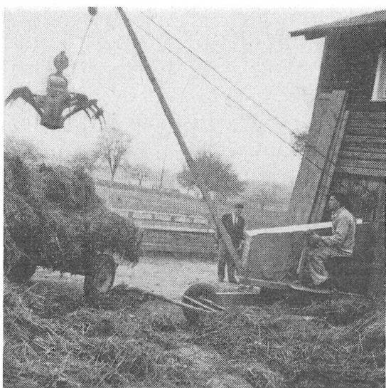
Fig. 1a et 1b: Grue mobile à fumier, équipée d'une pince à fonctionnement automatique (méthode de travail à un seul homme de service).
