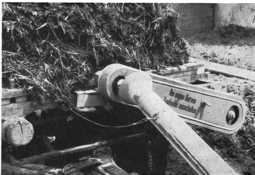
Fig. 3: Gaine protectrice entourant un arbre à cardans qui entraîne le mécanisme d'une épandeuse de fumier. (Pour de plus amples détails concernant les systèmes de protection destinés aux arbres à cardans, consulter la Feuille de recommandations M 8)
