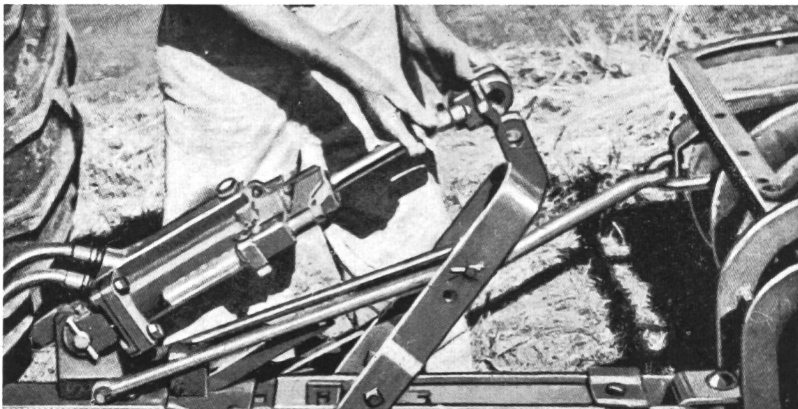
Fig. 6: Adaptation du vérin hydraulique au dispositif de relevage et d'abaissement d'un pulvérisateur attelé à un tracteur (fixation par chevilles à poignée).
