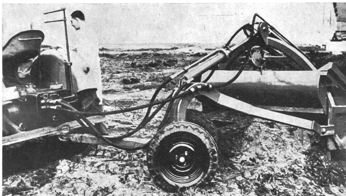
Fig. 4: Niveleuse accrochée à un tracteur lourd et pourvue de 2 vérins hydrauliques à double effet avec dispositifs limiteurs de course.
