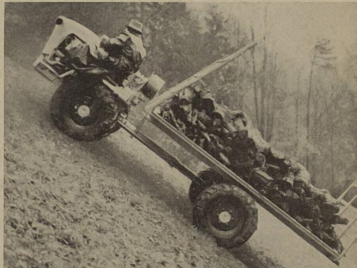
▲ En allongeant l'empattement et en équipant le PULLAX d'un plateau de charge, on obtient un véhicule tous-terrains aux performances étonnantes.
