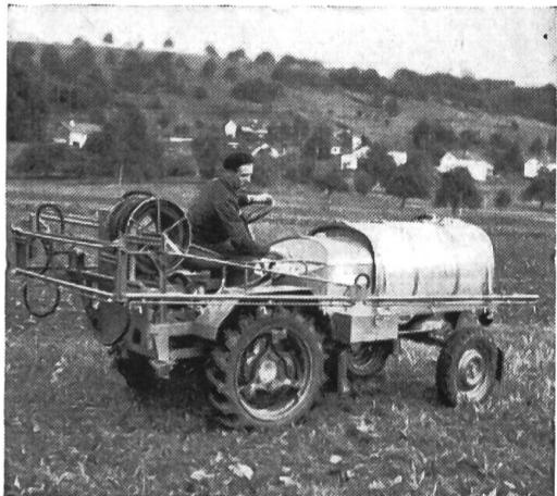
avec la pompe à haute pression BIMOTO-TITAN BH-II avec soupape de décharge automatique, avec le fameux moteur Boxer VW de 25 cv, 6 vitesses d'avancement, 1 marche arrière, dispositif très simple pour l'écartement des roues.
