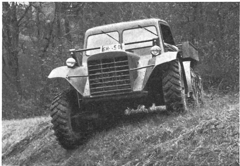
La longueur du «Flex-Trac» que nous avons vu dépasse quelque peu 4 m, son poids total s'élevant à 3 tonnes. Les 6 roues motrices comportent des pneus tous-terrains ordinaires. Disons encore que des types équipés de plus de 6 roues ont été également prévus.
