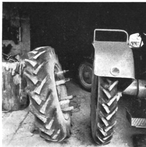
Fig. 12: Des efforts sont entrepris à l'heure actuelle par certains fabricants en vue de réduire à un minimum le temps exigé pour le montage et le démontage de doubles pneus (barillet de jumelage).
