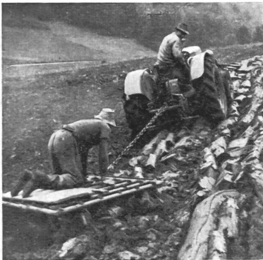
Fig. 1: Dans des conditions difficiles, on n'arrive pas à faire du bon travail avec un seul pneu par roue, même s'il est à large boudin (mauvaise adhérence, forte compression du sol, profondes ornières).
