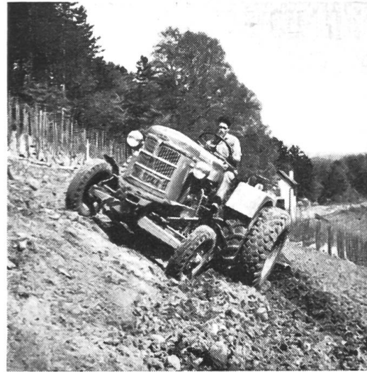
Fig. 4: Tracteur exécutant un hersage sur une pente avec des pneus jumelés. On notera que les roues arrière ne glissent pas de côté, comme ce serait le cas avec un seul pneu par roue.
