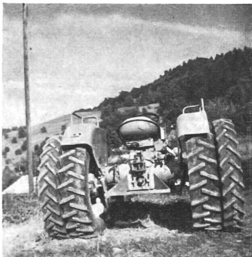
Fig. 9: Tracteur avec pneus jumelés de 8—32 et 10—28 pouces. Cette disposition est à recommander pour les époques où l'on ne doit pas exécuter de sarclages.
