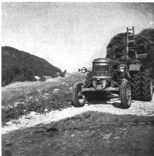
Fig. 11: Tracteur lourd utilisé seulement pour les transports (notamment sur des pentes) et équipé de 2 pneus jumelés 12-24.
