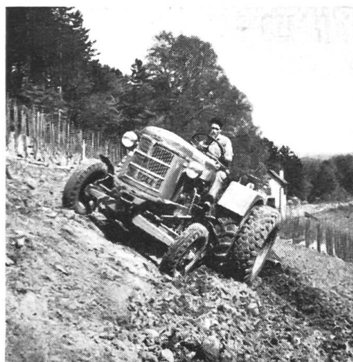
Fig. 4: Tracteur exécutant un hersage sur une pente avec des pneus jumelés. On notera que les roues arrière ne glissent pas de côté, comme ce serait le cas avec un seul pneu par roue.
