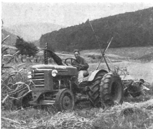
Fig. 7: Tracteur avec doubles pneus arrière accouplé à une moissonneuse-lieuse. Aucun dégât n'est causé à la culture double (mélange fourrager).
