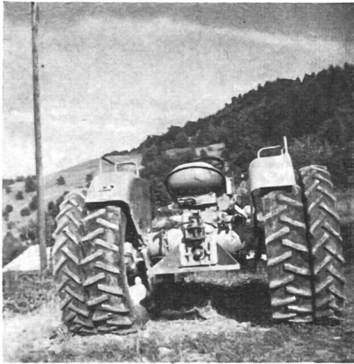
Fig. 9: Tracteur avec pneus jumelés de 8—32 et 10—28 pouces. Cette disposition est à recommander pour les époques où l'on ne doit pas exécuter de sarclages.
