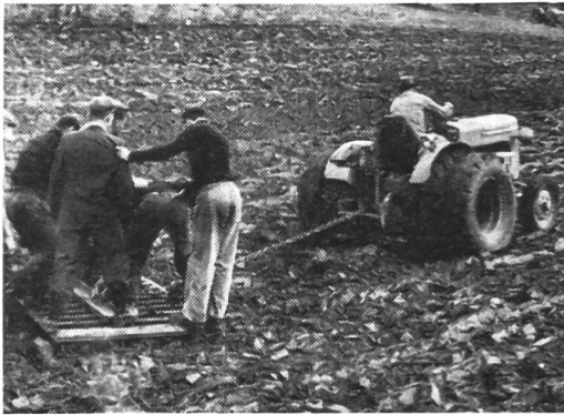
Fig. 3: Vue prise au cours d'une démonstration concernant la puissance de traction. En utilisant des pneus jumelés, on a pu constater qu'avec une même dépense d'énergie motrice, la force de traction était augmentée de 40 % (indication du dynamomètre).
