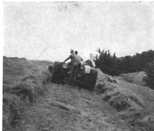
Fig. 8: Emploi du râteau andaineur frontal sur les terrains déclives grâce au jumelage des pneus.
