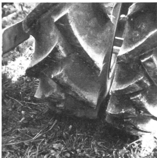
Fig. 13: Beaucoup ignorent que l'intervalle séparant les pneus jumelés doit être de 15 à 20 cm (auto-nettoyage). On remarquera ici que la couverture gazonnée n'est pour ainsi dire pas endommagée.
