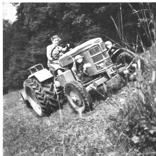
Fig. 14: Sur les terrains inclinés, les pneus jumelés rendent notamment service aux conducteurs encore inexpérimentés.
