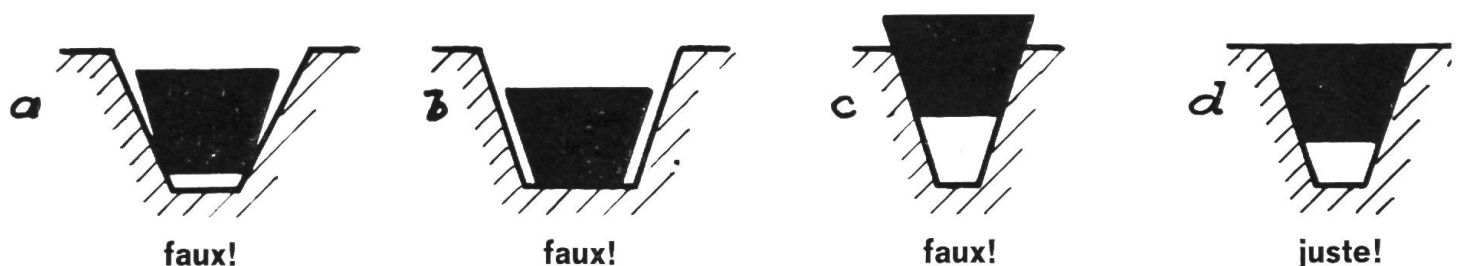
Fig. 3: Positions incorrectes et correcte de la courroie trapézoïdale dans sa gorge
