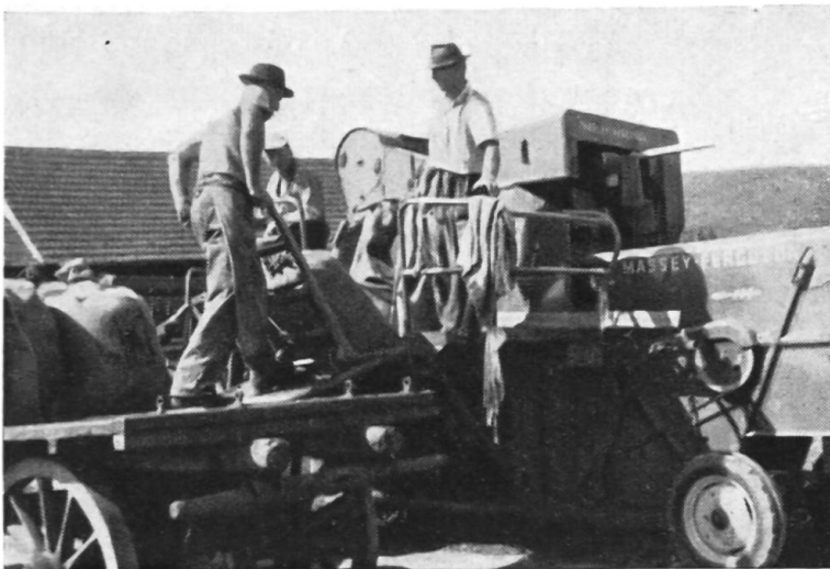
Fig. 3a: Transbordement des sacs de grain de la plate-forme de la moissonneuse-batteuse du pont d'un char amené à proximité.
