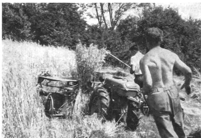
Fig. 2a et 2b: Tracteur à un essieu auquel est accouplé une moissonneuse-lieuse frontale dirigée par l'intermédiaire de roulettes de guidage et d'une barre de direction (travail exécuté sur une pente d'un degré d'inclinaison de 45‰).
