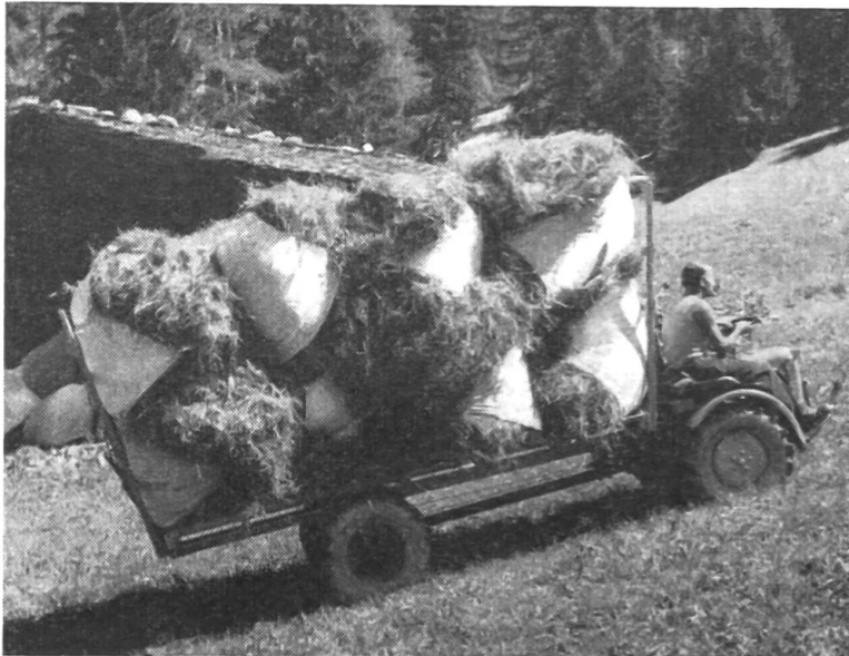
Fig. 2 Pullax employé en montagne pour rentrer du foin (travail agricole).
