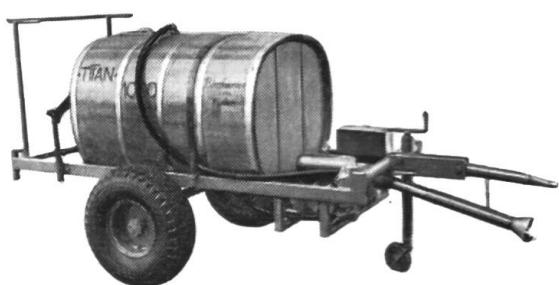
... le châssis indépendant avec la pompe BIMOTO-Titan BH-II, entraînée par arbre à cardans.
