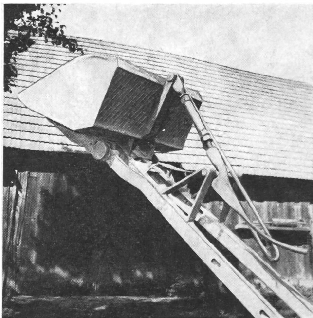
Fig. 2: La pelle du chargeur arrière en position de transport. — La pelle repose sur un support en forme de coin. Le levier à crochet, bien visible, est retenu par le barreau transversal du chevalet. Le crochet n'étant pas très long, il ne faut pas faire un grand effort pour soulever le levier avec la main.
