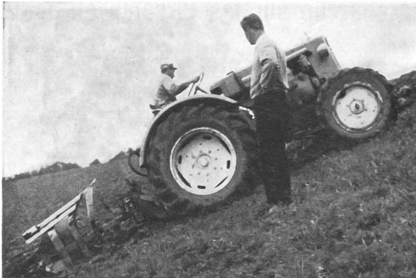
Fig. 2: Labourage exécuté suivant le sens de la plus grande pente sur un terrain accusant un degré d'inclinaison de 37 ‰ (tracteur de 35 ch, à 4 roues motrices).
