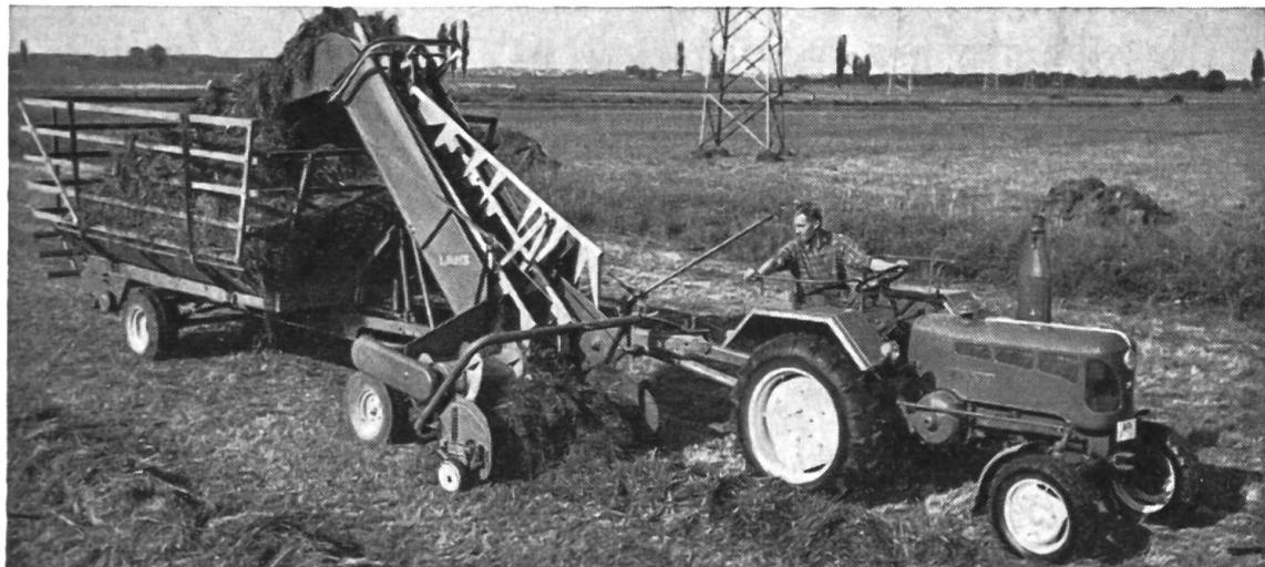
Le LANZ-Diesel avec la chargeuse combinée LANZ SL 160 et la remorque monoaxe à emploi multiple LADUS 3. Avec la chargeuse combinée un homme seul charge le foin, les fourrages verts, le maïs, etc.
