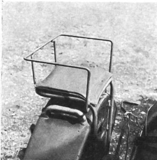
Fig. 2a Modèle de siège auxiliaire bien rembourré aménagé sur un garde-boue.
