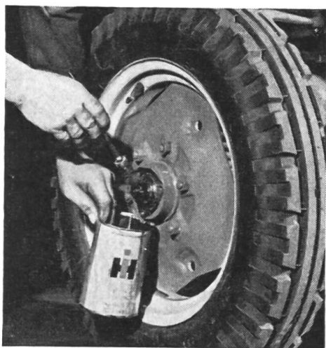
Fig. 2 Après avoir enlevé le chapeau de moyeu, il faut nettoyer l'écrou crénelé avec soin.
