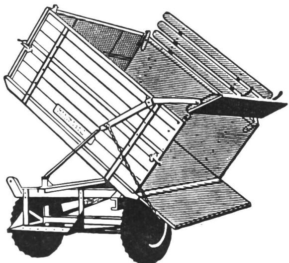
Le nouveau modèle de tombereau à basculeur représenté ci-dessus offre ceci d'intéressant que l'un de ses panneaux latéraux s'ouvre automatiquement au moment où la benne est culbutée. On remarquera le grand angle de basculement de celle-ci, qui se révèle très pratique. La machine de récolte est entraînée par un arbre à cardans fixé sous le châssis du tombereau. Elle-même s'accroche à la barre d'attelage qui est aménagée à l'arrière de ce dernier.
