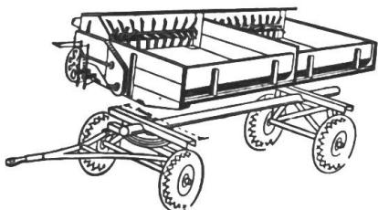
Il existe cependant de nombreuses exploitations qui possèdent déjà un char à plusieurs usages, pourvu de pneus, et qui peut être équipé de diverses superstructures. C'est pour ces cas-là qu'a été créé la caisse amovible «Mécanicus», prévue pour épandre le fumier, et qui se monte sur le châssis du char.
