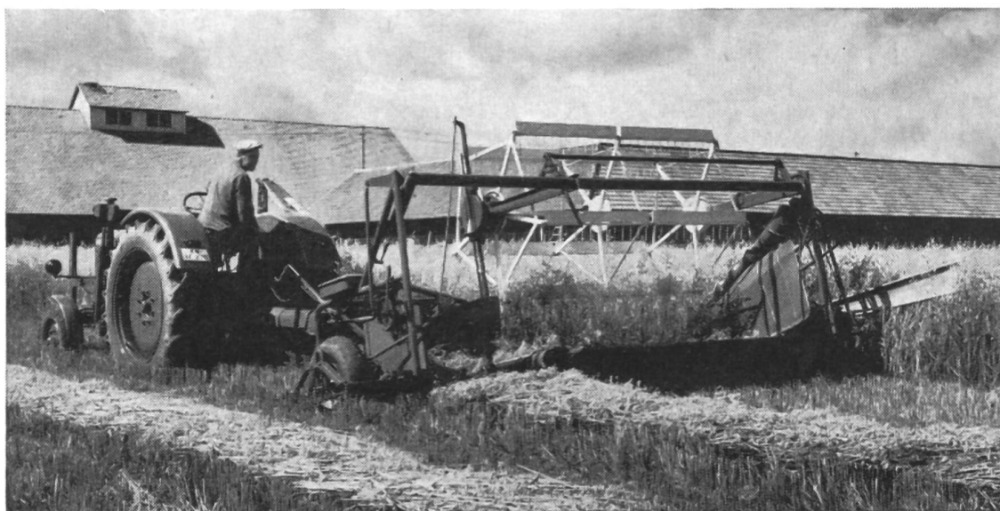
Fig. 1: L'andaineuse moissonne sur un front de travail de 2 m 40 et dépose la récolte en andain continu sur des éteules d'environ 20 cm de haut.
