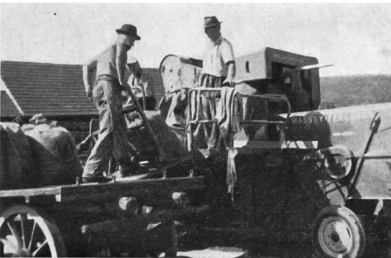
Fig. 6a: Transbordement des sacs de grain de la plate-forme de la moissonneuse-batteuse au pont du char de récolte (emploi d'un diable à sacs).
