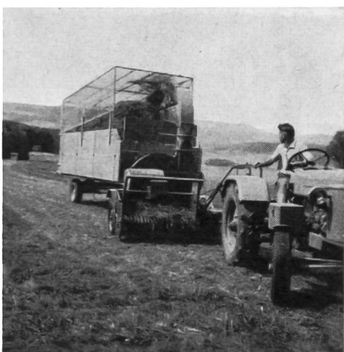
Fig. 7c et 7d: Véhicule de récolte à fond mouvant, équipé de ridelles spéciales surmontées de cadres treillisés.
