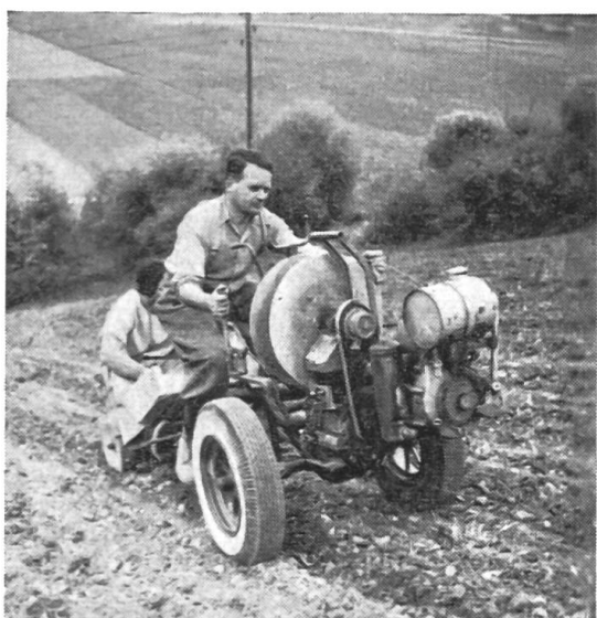
Fig. 1a: L'«araignée», équipée d'une planteuse semi-automatique à pommes de terre, vue en action sur une pente de 40 % de déclivité.
