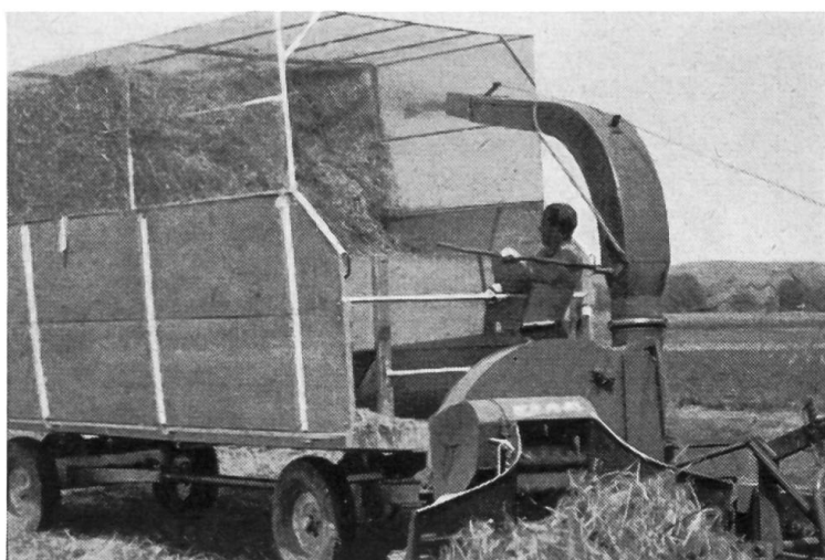
Fig. 7c et 7d: Véhicule de récolte à fond mouvant, équipé de ridelles spéciales surmontées de cadres treillisés.
