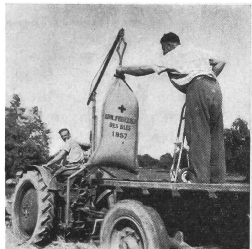
Fig. 6a: Transbordement des sacs de grain de la plate-forme de la moissonneuse-batteuse au pont du char de récolte (emploi d'un diable à sacs).
