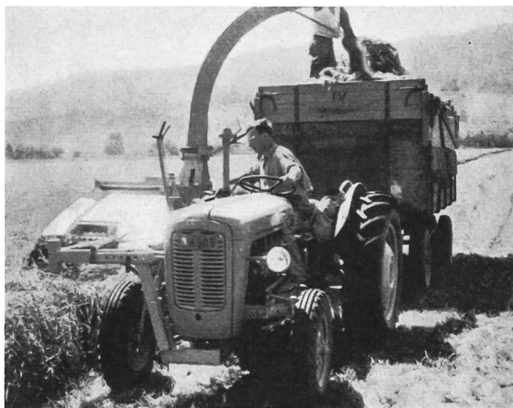
Fig. 7a et 7b: Vue de la ramasseuse-hacheuse-chargeuse au travail, accompagnée d'un véhicule de récolte spécial à hausses et surhausses.
