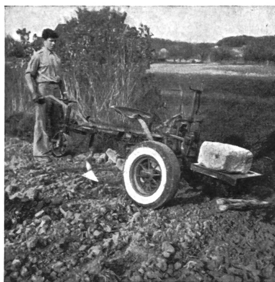
Fig. 3b: Le virage de l'«araignée» avec son instrument de travail (butteuse).
