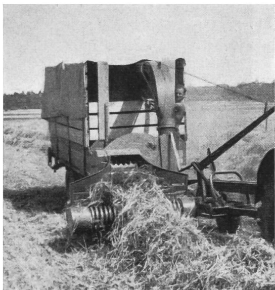
Fig. 7a et 7b: Vue de la ramasseuse-hacheuse-chargeuse au travail, accompagnée d'un véhicule de récolte spécial à hausses et surhausses.
