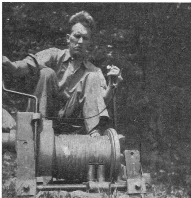
Fig. 1: Les engrenages et les arbres doivent être pourvus de dispositifs de protection. Tous les leviers de commande (pour le freinage et l'embrayage) sont à aménager de telle façon qu'ils puissent être manœuvrés facilement, le corps restant dans une position commode. On évitera de combiner la commande de l'embrayage et du frein dans un seul levier.
