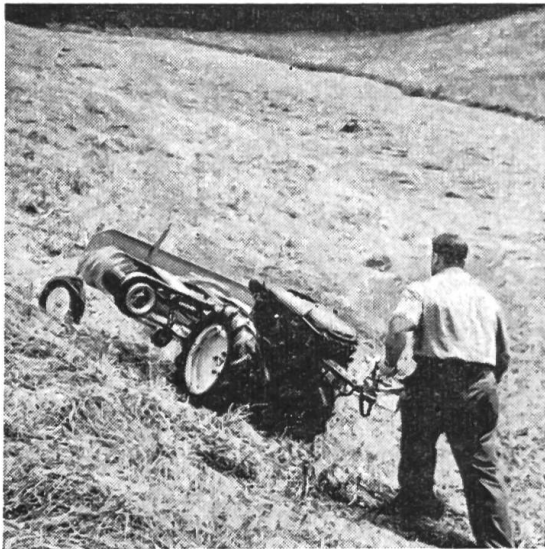
Fig. 3a et 3b: Faneuse à chaîne à râteaux et râteau andaineur à disques mis en service sur des terrains d'une pente allant de 40 à 45 ‰. Avec un tel degré d'inclinaison, on est obligé d'utiliser le râteau andaineur à disques dans le sens de la pente.
