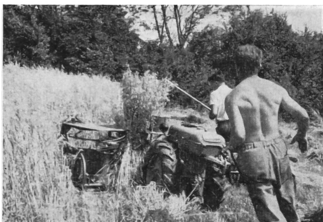
Fig. 2a et 2b: Tracteur à un essieu avec moissonneuse-lieuse spéciale accouplée frontalement et équipée de deux roulettes de direction. Travail effectué sur un terrain d'un degré d'inclinaison de 45%. (L'acquisition d'une telle moissonneuse-lieuse représente plutôt un problème économique que technique.)
