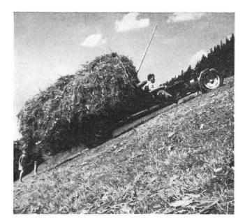
Fig. 1: Remorque à essieu moteur accouplée à un tracteur à un essieu sur une pente fortement inclinée.
