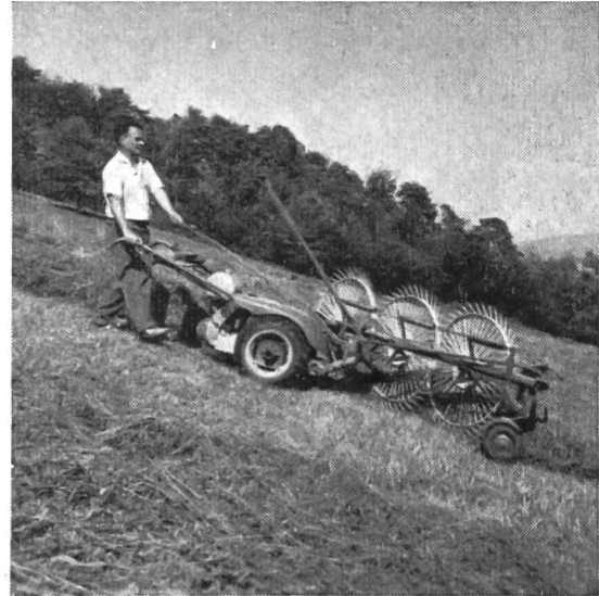
Fig. 3a et 3b: Faneuse à chaîne à râteaux et râteau andaineur à disques mis en service sur des terrains d'une pente allant de 40 à 45 ‰. Avec un tel degré d'inclinaison, on est obligé d'utiliser le râteau andaineur à disques dans le sens de la pente.
