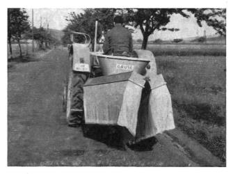
Fig. 3: L'abrivent est replié vers l'arrière pour le transport sur route.
