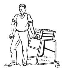
Fig. 2: Traîneau plus élevé pouvant être déplacé avec un moindre effort.
