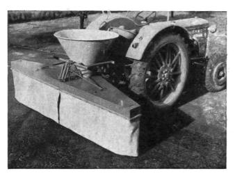
Fig. 2: Abrivent se fixant à l'épandeuse d'engrais «Gruse» à force centrifuge (largeur de travail; 3 m).
