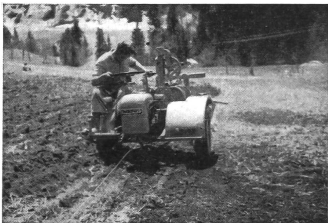
Le labourage au treuil avec un seul homme de service se déroule à bonne allure et sans peine en utilisant le «Pullax».
