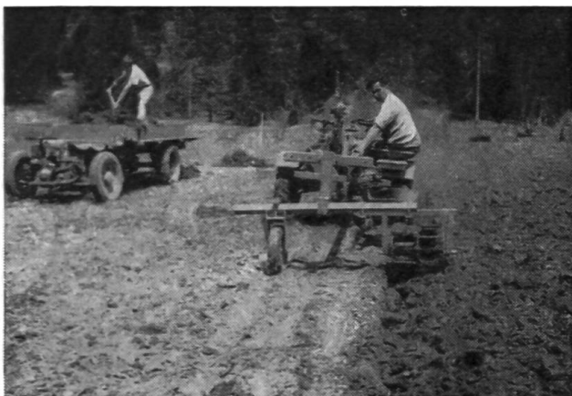
Les travaux exécutés suivant le sens de la plus grande pente exigent la descente à vide de l'instrument. La herse roulante spéciale dont est équipé le «Pullax» comble cette lacune. Elle permet de herser le champ en descendant et d'obtenir en un aller et retour une terre prête à recevoir la semence.
