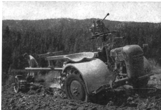
Le labourage au treuil avec un seul homme de service se déroule à bonne allure et sans peine en utilisant le «Pullax».
