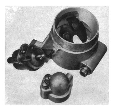
Fig. 11: Appareil économiseur «Régulateur Otto»
