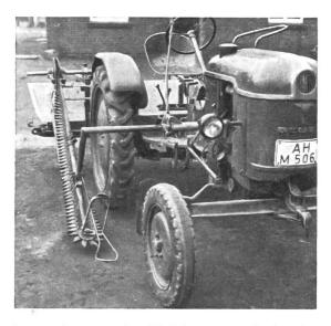
La machine portée «Ziehfix» pour récolter les betteraves. La chaîne arracheuse que l'on voit à gauche comporte des pinces en matière plastique. Les betteraves sont saisies par les pinces se trouvant à l'extrémité antérieure de la chaîne et conduites dans le récipient collecteur disposé à l'arrière du tracteur.
