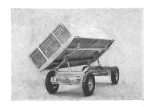
A propos d'un récent article où il était fait alllusion à des fabrications allemandes dans le domaine des remorques à pont basculant, la firme Andres, construction de remorques, Lyss (BE), nous rend attentifs au fait qu'elle fabrique également des remorques à plateau basculant ainsi que des dispositifs de basculage amovibles à monter en tout temps sur les chars destinés à la traction motorisée (fig. 1).
