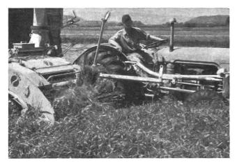
Fig. 4: En employant la ramasseuse-hacheuse-chargeuse et une barre de coupe, il est possible d'effectuer la récolte totale des fourrages en une seule opération.
