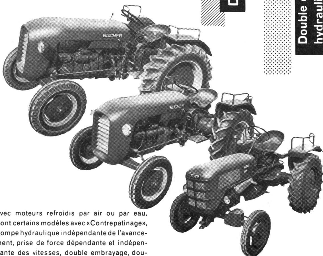
avec moteurs refroidis par air ou par eau, dont certains modèles avec «Contrepatinage», pompe hydraulique indépendante de l'avancement, prise de force dépendante et indépendante des vitesses, double embrayage, double distribution au relevage hydraulique, commande incorporée à deux vitesses pour la barre de coupe.
